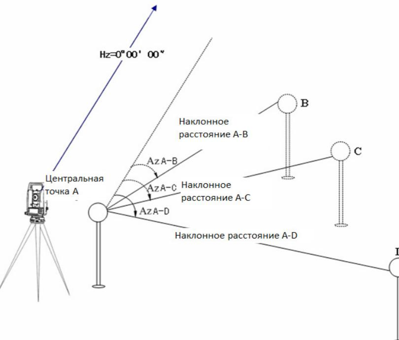
2. Способ измерения недоступной линии (A-B, B-C): измерение выполняется по принципу A-B, B-C, C-D, .....
