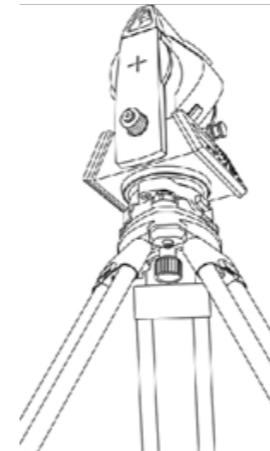
(2) Фиксация прибора на основании штатива: аккуратно установите прибор на основание штатива. Придерживая его одной рукой, затяните становой винт в нижней части прибора, чтобы надежно закрепить его на штативе.
