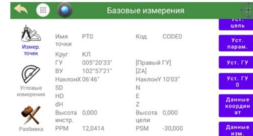
В центральной части окна базовых измерений расположена информация об измерениях в выбранном режиме. В правой же части расположены клавиши для управления измерениями в выбранном режиме.
