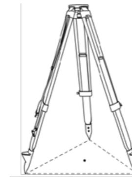
(1) Сначала установите штатив: выдвиньте телескопические ножки на необходимую длину и плотно затяните винты. Убедитесь, что ножки расположены на одинаковом расстоянии друг от друга, а головка штатива приблизительно выровнена по горизонтали. Установите штатив таким образом, чтобы головка находилась над точкой съемки. Убедитесь, что ножки штатива надежно зафиксированы в земле.
