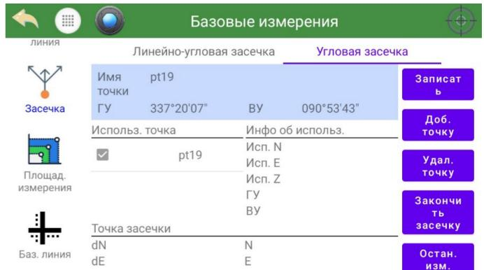
6) Повторите пункты 4) и 5) для следующих двух опорных пунктов, после чего появится диалоговое окно, в котором отображены координаты определяемой точки, и можно нажать клавишу «Уст. станцию» или нажать «Отмена» для продолжения измерений.
