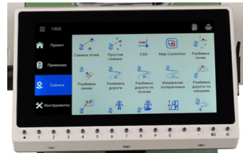
Рисунок 4 – Экран и клавиатура тахеометра RTS362N и RTS010N
