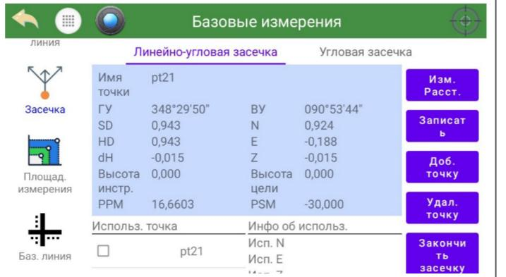
6) Повторите пункты 4) и 5) для следующего опорного пункта, после чего появится диалоговое окно, в котором отображены координаты определяемой точки, и можно нажать клавишу «Уст. станцию» или нажать «Отмена» для продолжения измерений.
