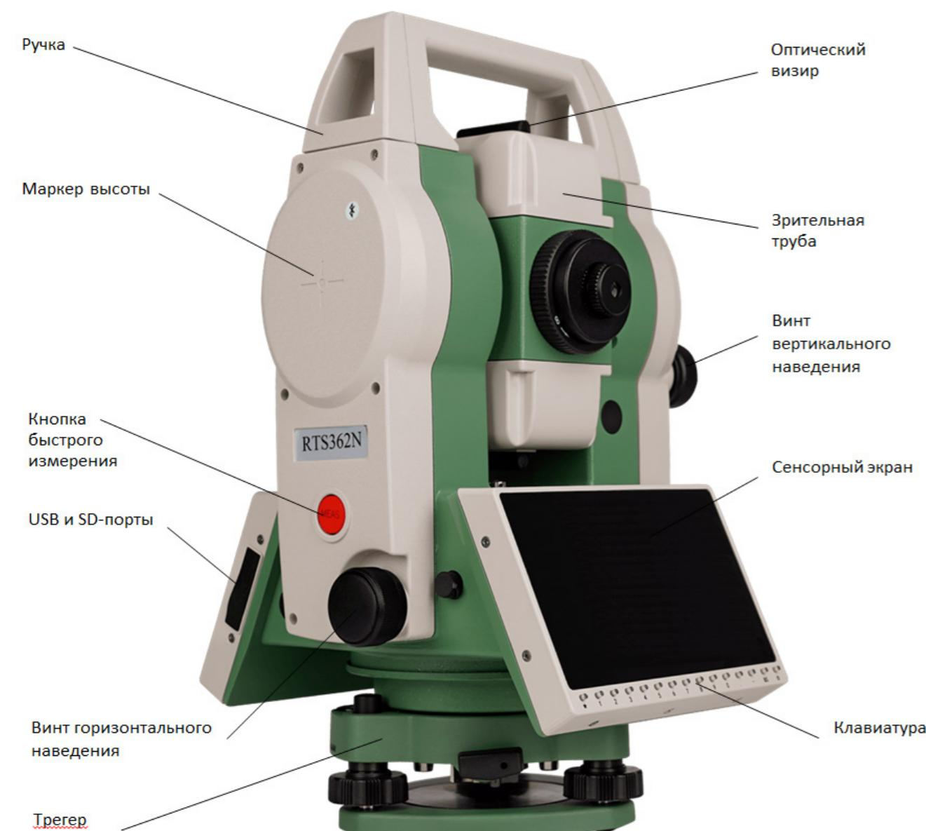
Рисунок 3 - Основные элементы тахеометра RTS362N и RTS010N
