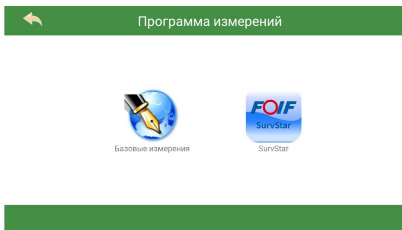
Для перехода к режиму базовых измерений необходимо зайти в меню «Программа измерений» и нажать на «Базовые измерения». Данная функция применяется для измерений и вычислений, в том числе, для измерения углов, измерения расстояний и измерения координат.
