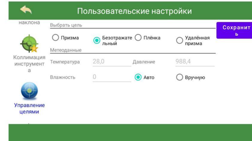
Выберите Призма/Безотражательный/Пленка/Удаленная призма в пункте «Выбрать цель», чтобы изменить тип цели, на которую направлен тахеометр.
